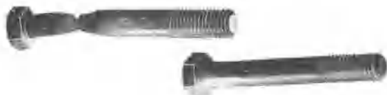
圖11、一般螺釘的抗張位置
