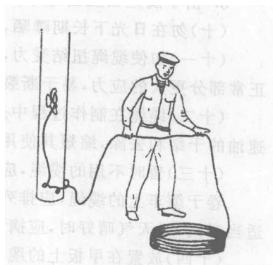
图 1—10 一端固定缆绳的错误盘法
