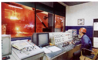
抚钢股份公司第一炼钢厂50吨超高功率电弧炉
