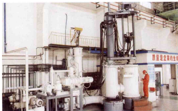
抚钢股份公司第三炼钢厂7吨自耗炉
