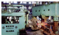
抚钢股份公司锻造厂2000吨快锻机
