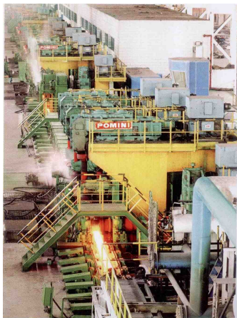
抚顺钢铁股份公司连轧厂24架连轧生产线
