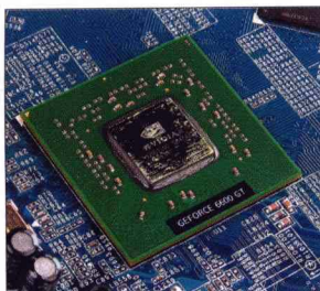
内部的确是 NVIDIA GeForce 6600 GT 核心
