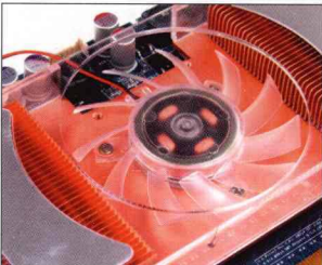
华硕这款产品同样运用了铜质散热片，但却只配备了一个 11 叶的散热风扇。
