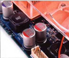
大量高品质的铝壳电容和复杂的供电系统
