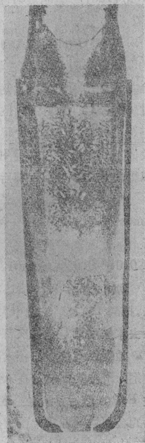
图 4 钢锭的低倍放射性照相法( P^{32} )
