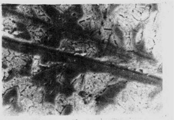
图 3 马氏体 Cr20% 白口铸铁表面切削沟形貌 (SEM 二次电子像)
