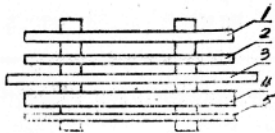
圖 7 距壓板為 90 公厘時的絕緣結構
