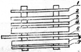
圖 6 距壓板為 110 公厘時的絕緣結構
