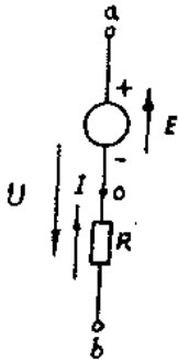
图1-5 一段有源电路
