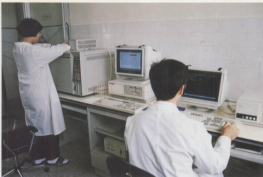
动植物产品检验室人员用气相色谱检验残留有毒物质
