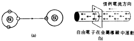
圖 1-1 (a) 電子移動；(b) 電流與電子流方向
