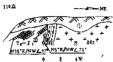
图7 小得石李明久断层剖面 ①残坡积层；②白果湾群砂页岩 (T 3 -J 1 )；③断层破碎带；④碎裂状基性岩脉；⑤晋宁期石英闪长岩 (δo 2 )。
