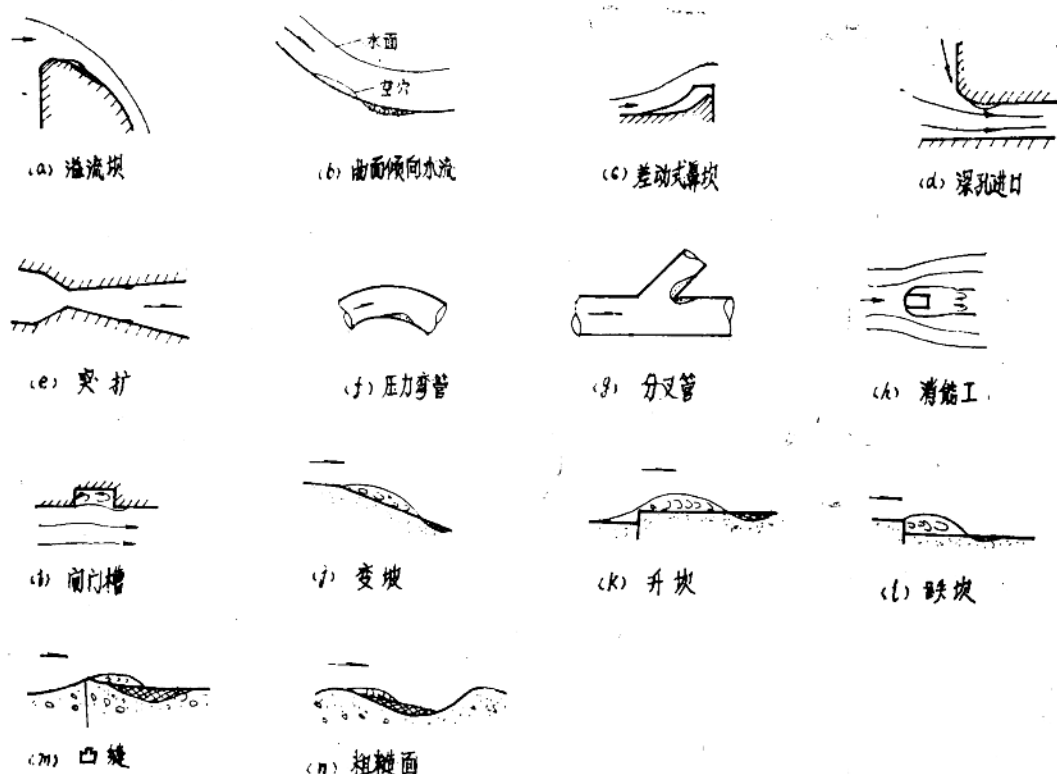
图 1—5 负压可能出现的部位及表面不平整度影响下的流态与空蚀
