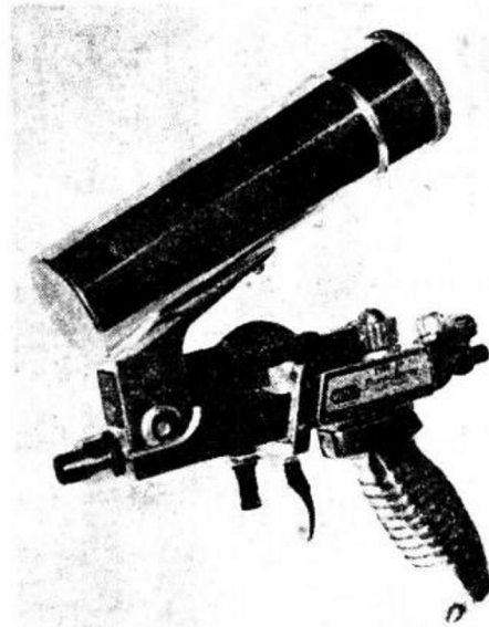
図 2.6 粉末式ガス溶射トーチの外観
