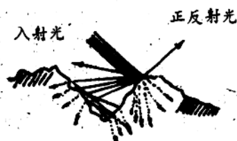
图3 微裂纤维光反射特性示意图
