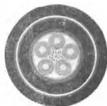
图3. 标号KCPB電纜横断面
