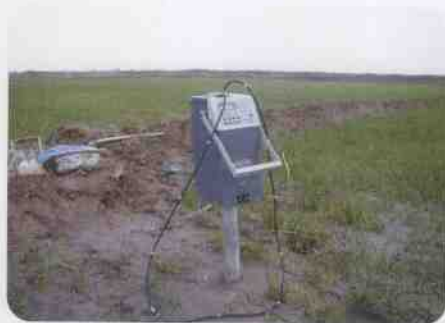
我校董新光教授主持的“干旱内陆河流域水盐监测与模型应用研究项目”2006年获自治区科技进步二等奖。图为利用中子水分仪测定土壤含水量。
