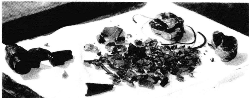
图 1.2 活塞咬住后果造成发动机完全损伤
