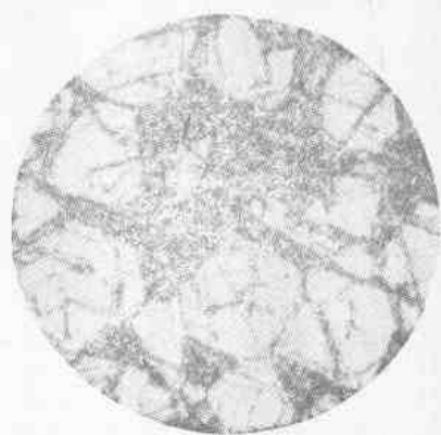
图3-6 炉渣中的锰尖晶石
