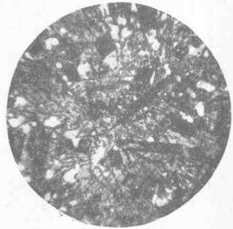
图3-15 高钛炉渣中的钙钛矿和安德石
