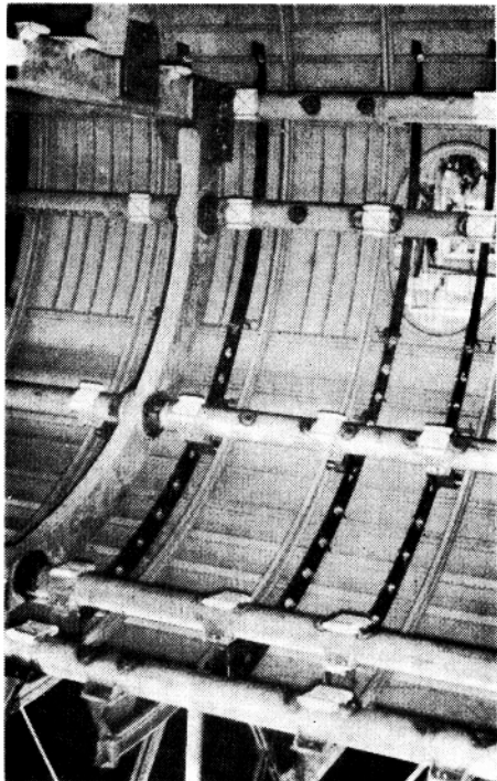
2-7 “先锋”号飞机机身装配时的 内侧视图。壁板用支持在管子 纵向构件上的内型板定位
