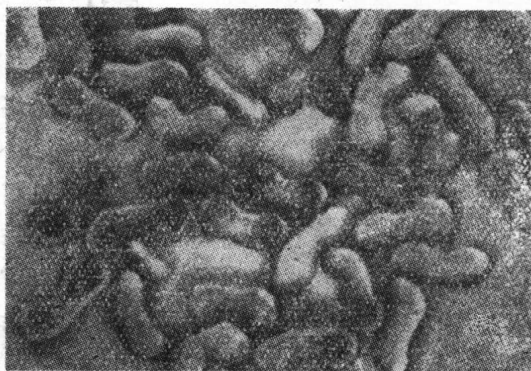
图12 70°C的温度凝 固浴纺制的纤维断面
