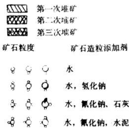
图1 1983年6月以前上堆矿石的制备方法概要
