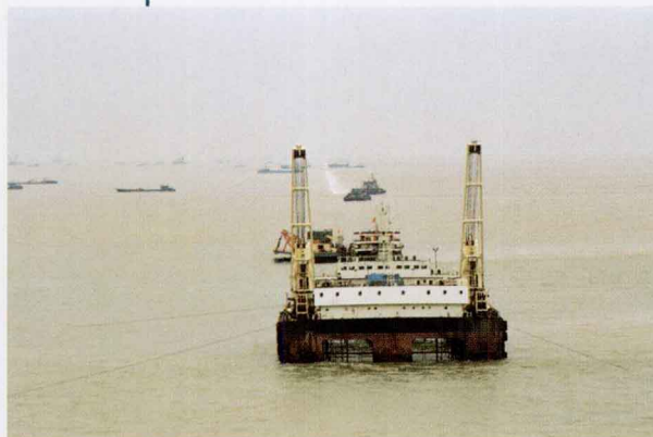
首创的基床抛石整平船，日最高抛石 6000 m 3 ，整平 1620 m 2 。
