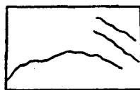
b. 橫隔牆開裂
