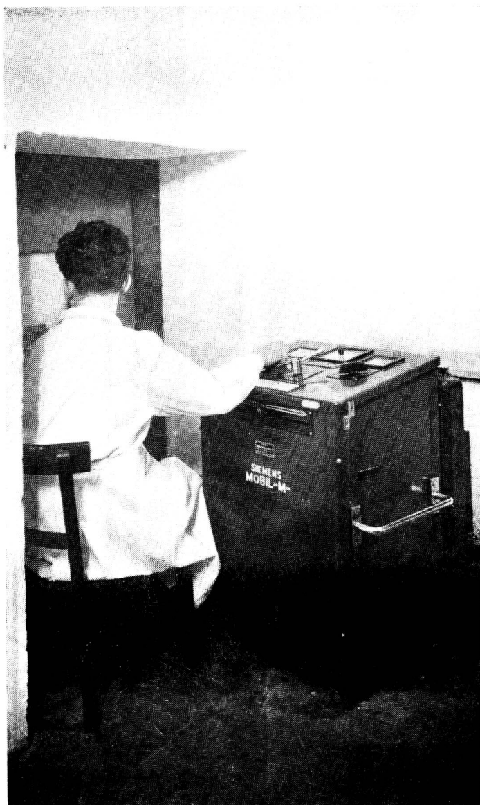
第五圖 工作人員在鄰室控制X光機對準試樣發射X光(試樣後爲攝影片匣)
