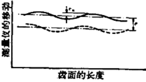
图31 表面波度的振幅 lu 与节距误差 c
