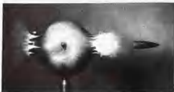
這顆時速一萬五千里的子彈，就是被配有聲控同步裝置的高速閃燈攝入鏡頭。
