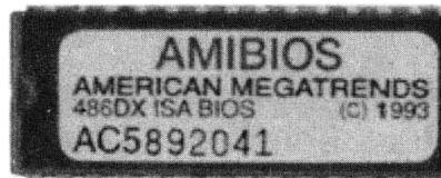
CMOS 需要通过 BIOS 中存储的程序进行修改，BIOS 程序可以看作是电脑中运行在最底层的软件，就像系统硬件与其他软件间的一个接口程序，负责解决硬件的即时需求，并按软件对硬件的操作要求具体执行。计算机用户在使用计算机的过程中，都会接触到 BIOS。可见，它在计算机系统中起着非常重要的作用。
