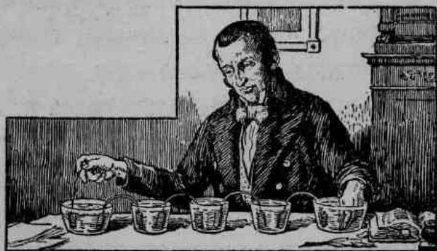
弗打用食鹽水杯中，放入銅條與鋅條，互相串聯即成電堆，可以發電。
