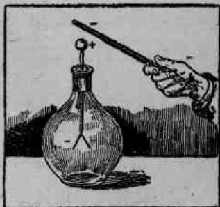
此磨擦後琥珀棒載有陰電荷，靠近驗電器上端金屬球，下面二金箔，立即分開。
