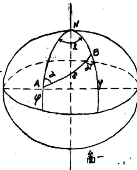
方位角為  $\alpha$ ， $B$  點為所求點，設其經緯度為  $\lambda'$ ， $\varphi'$ ， $B$  至  $A$  之反方位角為  $180 + \alpha'$ ，又如圖二。設有極靠近的兩點  $P$ ， $P'$ ，其間距離為  $ds$ ，過  $P$  及  $P'$  點作兩平行圈由  $P$  點作子午圈切綫和地軸相交於  $V$ ，
