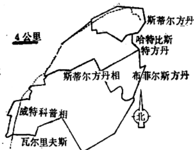
图1 Klerksdorp金矿公司采矿平面图示Vaal Reef古砂矿的斯蒂尔方丹(Stilfontein)和威特科普(Witkop)相的分布
