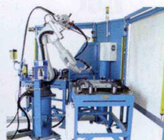
机器人焊接系统
