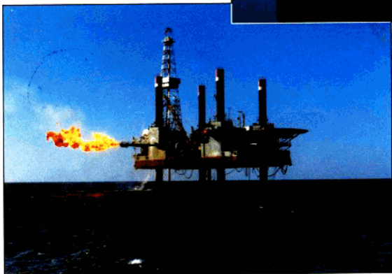
圖爲渤海五號自升式鑽井船正在錦州20-2-1井試油。實踐證明，它在作業海況、風暴自存條件、鑽井能力、可變負荷及設備配備水平等主要性能方面都達到了當時國際上同類鑽井船的水平。
