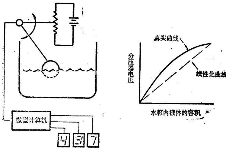
这种应用常常会有复杂的问题。在此情况下，浮标和“电位计”不能产生一种随加仑数或者随液面离箱底的距离增加而直线上升（即成比例）的电压，因为当杆随液面落下时，电位计的轴愈转愈快。例如，汽车中的油量计就是用这种方式组装的，并且随着它们愈接近“空”而下降愈快。所以我们希望微型计算机能作这种非线性补偿，并且给出精确反映箱内加仑数的输出读数。
