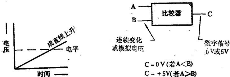
用积分电路可以产生等斜率上升电压，该电路输入信号可能是一组电压（如 +5 伏），并且依照输入电压的大小和接通时间的长短产生输出。换句话说，它又产生一种线性上升电压：即电压与时间关系图是一条直线。
