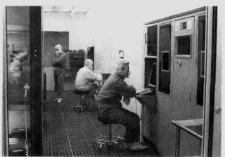
集成电路制造线10级超净室的一角:离子注入机、多晶硅(PECVD)设备、金属薄膜溅射沉积设备、外延炉、扩散炉、设备过墙安装
