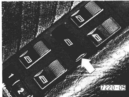
安全开关(箭头所示)可使后门的开关和后排中间支架上的点烟器失去作用，只有安全开关按下，后门的开关和点烟器才恢复功能。
