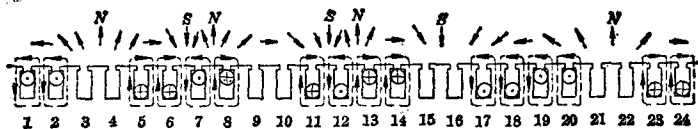
图5 一相绕组中有一只线圈接反(7至11槽中的线圈), 图中示一相通入直流时, 磁针在不同位置所指的方向, 小箭头代表磁针方向, 虚线代表磁力线方向
