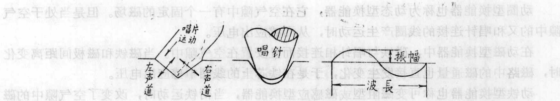
图1 唱片声槽中的立体声信号、声槽中的唱针配合、以及振幅和波长的关系。
