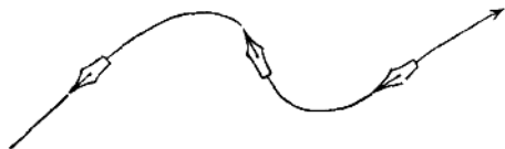
图 2-6 笔尖与绘线方向的关系
