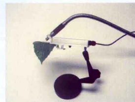
PAR 叶夹(测量ETR 自然光下 PAR 和 叶温)
