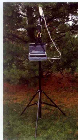
PAR 叶夹(测量ETR 自然光下 PAR 和 叶温)
