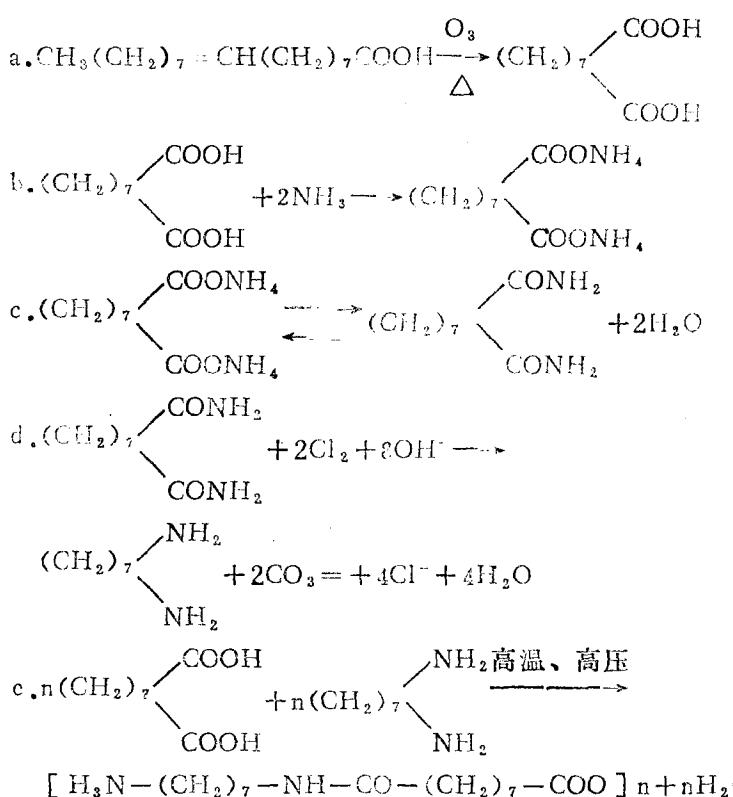
聚酰胺79是以壬酸和庚二胺为原料，通过适当的方法制成粘稠的溶液，经喷丝头（其孔径大约在0.04—1.0毫米之间）将粘液喷出到空气中或某种特定的液体中凝固成细丝。
