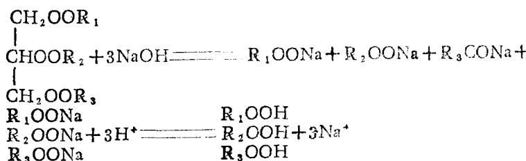
其方法是：先将蛹油注入反应锅中，加入同体积的水，直接通入蒸汽至沸腾，缓缓加36—40°Be液体烧碱，加液碱量为蛹油重量的50%，边加边搅拌，在100—110℃条件下，反应7—8小时，直到皂化完成。皂化完成的简单检验方法是将皂化液滴入水中，如无油花升起浮即表示皂化完成。皂化完成之后，放冷、静置6—12小时，放出下层下脚水，供回收甘油用。上层皂粒移入耐酸反应锅，加入等量的水，用直接蒸汽加热，使之熔化，然后徐徐加入工业硫酸（比重1.84），加酸量为加碱量的60%左右，再继续加热45分钟左右，静置分层，下层是废酸和盐液，放走，上层即为脂肪酸。
