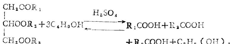
将蚕蛹油、正丁醇和浓硫酸以1:1.1:0.01的比例投料于反应釜内，在120—125°C回流8小时，用水洗涤以除去磷酸和甘油。再用氢氧化钠溶液中和其中的游离脂肪酸，最后在脱醇锅内加热回收正丁醇。正丁醇收集完毕后，在740毫米汞柱的真空调条件下，收集180—230°C的馏分，此馏分称为
