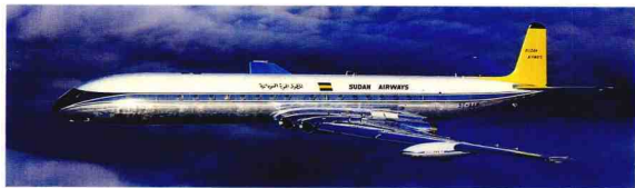
噴射先驅 英國德哈維蘭公司的彗星型客機是第一架噴射民機機，一九四九年首次飛航。雖然數次空難使彗星的名聲受損，但後來發現失事出於金屬疲勞，改良後便能提供完善服務。
