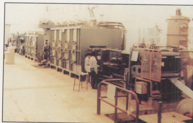
引进的电冰箱铝蒸发器自动生产线
