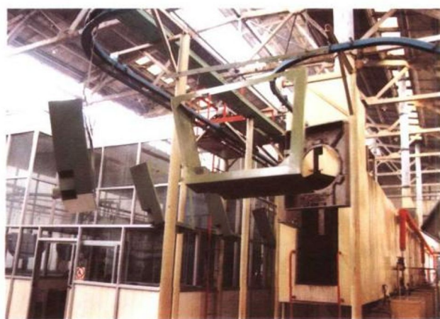
从英国eurotec公司引进的YLUDA静电喷粉生产线,该线通过最大工件尺寸2000×500×1500mm(长×宽×高)
