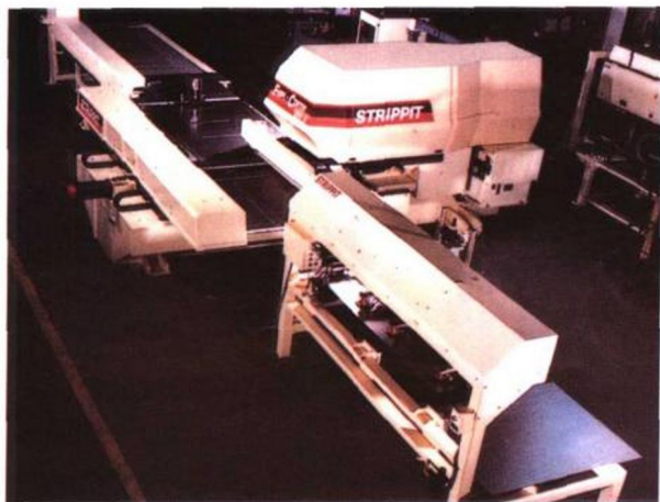
从美国STRIPPIT公司引进的FC-1250S数控钣金加工中心(自动上/卸料系统),加工最大工件尺寸4064×1536mm,最大板厚9.5mm。
