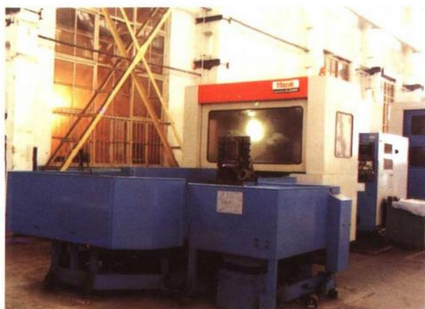
从日本MAZAK公司引进的H-630N卧式柔性加工单元,有6工作台,工作台尺寸630×630mm。
