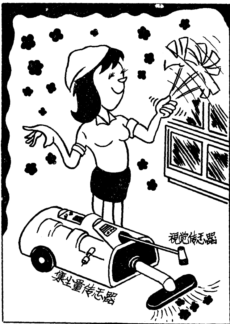
全自动清扫机上的微型机根据灰尘种类和集尘量调整吸尘力。
