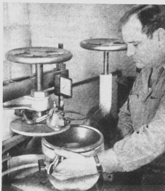
圖 2 套好砂箱後準備澆入熔融的低熔點合金
