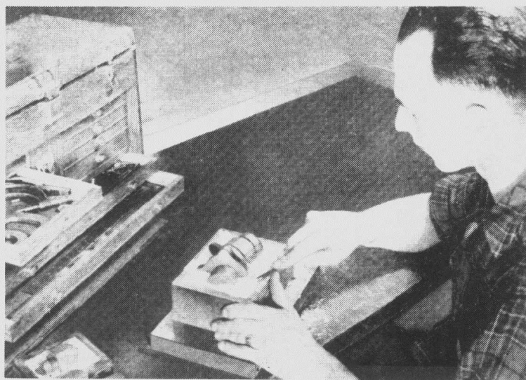
圖 1 將原模型的一半用石膏覆蓋起來
