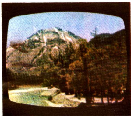
四十八、高壓電路有放電現象
