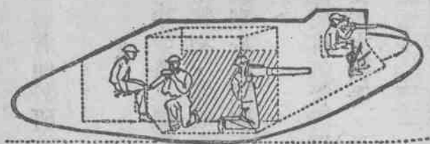
第三圖 馬克IV型戰車之斷面
