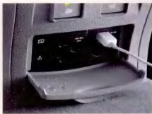
■ USB接口+AUX-IN音频接口： 连接多种数码产品，轻松选择自我音乐。
