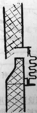
图 2-5 有内衬的膨胀节示意图
