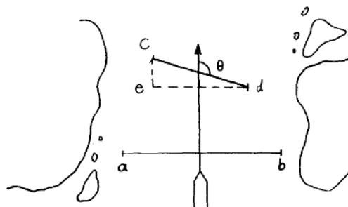
因舰船的航线与雷线不垂直，应将雷线长cd转换成垂直于航线的投影ed，即 $ed = cd \cdot \sin\theta$ ，为构成雷线障碍的长度。根据(2.2)式
